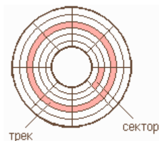
Рис. 2.7. Поверхность магнитного диска
