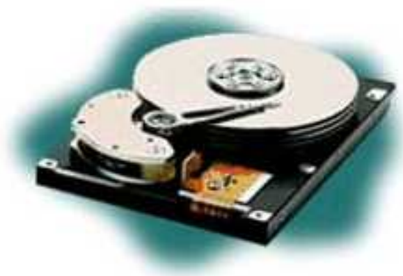
Рис. 2.8. Винчестерский накопитель со снятой крышкой корпуса
